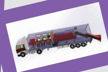
У причепі розташований завантажувальний контейнер з бункером, що автоматично за допомогою лебідок з нього виїжджає. З бункера сміття рухається конвеєрною стрічкою, після чого тверді відходи потрапляють до сепаратора. Окремий конвеєр відводить органічні відходи в спеціальні місткості. Далі працівники вручну розбирають папір, пластик і плівку, а магнітний сепаратор відділяє метал.
